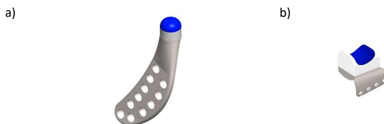
Figura – Superfície articular. (a) componente mandibular; (b) Componente fossa craniana
