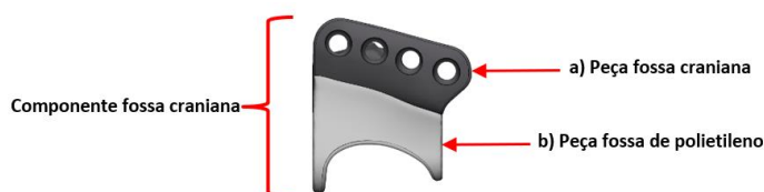
Figura – Componente fossa craniana composto pelos seguintes itens: (a) Peça fossa craniana; (b) Peça fossa de polietileno.
